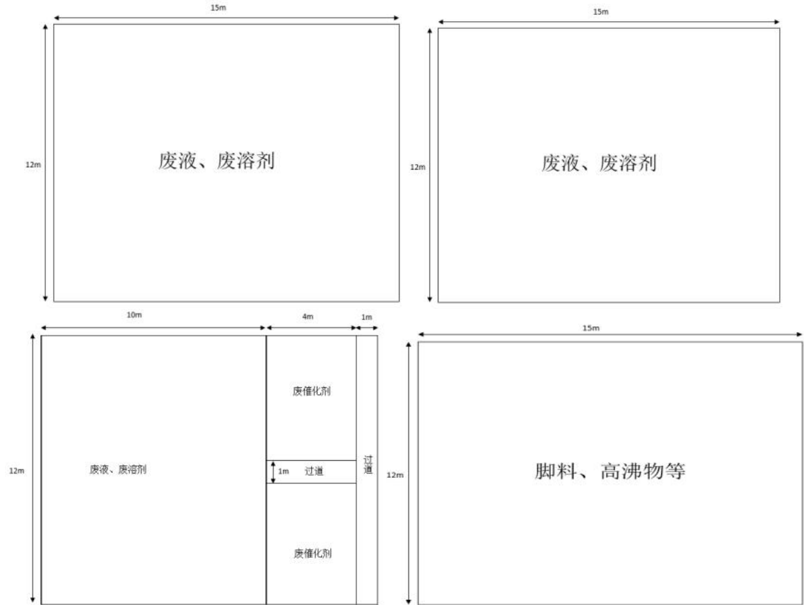
图7.5-3 3#危废库布局图（共4个房间）
